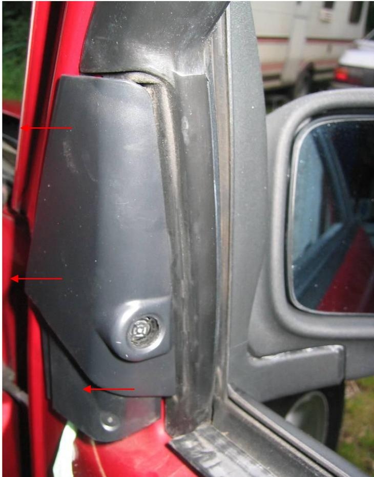
Déposer les 5 vis (torx) maintenant le rétroviseur
