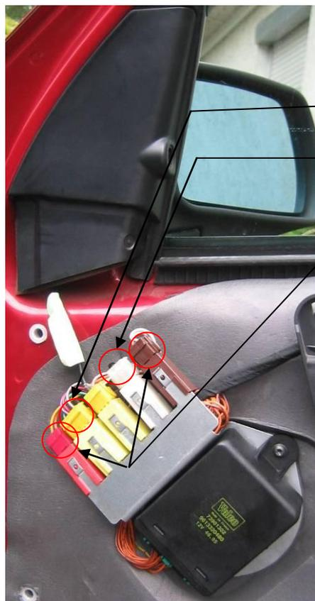
Le rétroviseur électrique droit indexé dispose de quatre prises qui le connectent au véhicule ; ces prises sont accessibles après dépose de la garniture intérieure de la porte :
