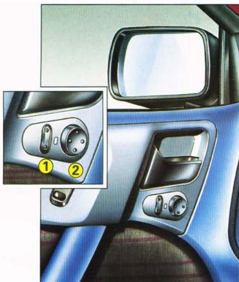
Le dégivrage des miroirs des rétroviseurs est couplé avec le désembuage électrique de la lunette arrière\*.
