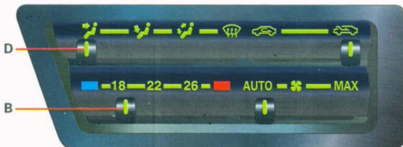
La température peut être modulée par la commande **B**. A gauche; le plus froid, à droite; le plus chaud.
