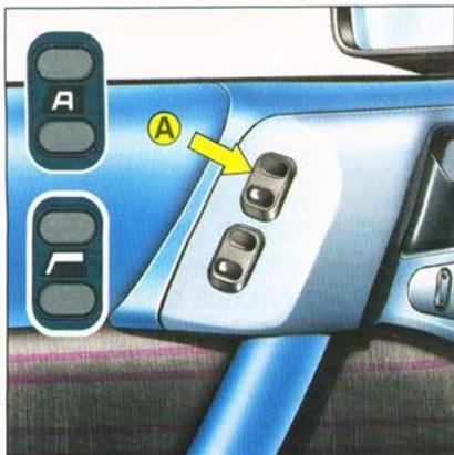
Les vitres arrière électriques\* sont actionnées à l'aide des interrupteurs placés sur la console.
