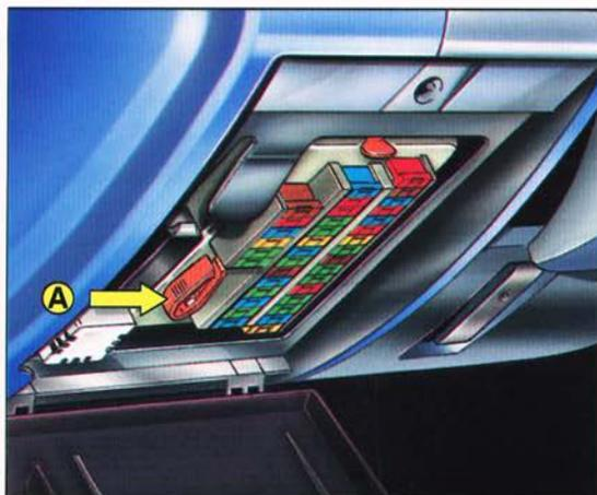
Les six fusibles (sans numéro) placés au dessus de la pince, sont des fusibles de rechange.
