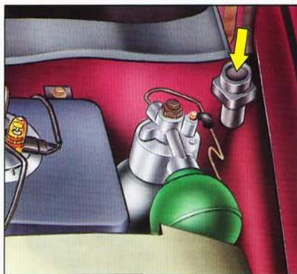
En cas de coupure, pour rétablir cette alimentation en carburant, appuyez sur la partie supérieure de l'interrupteur selon schéma.
