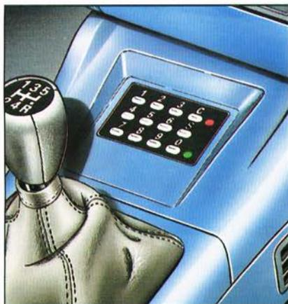
La saisie d'un code confidentiel au clavier d'antidémarrage codé permet le déverrouillage du système de mise en marche du moteur.
