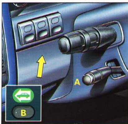
La commande du régulateur **A** est située sous la commande d'éclairage et de signalisation.
