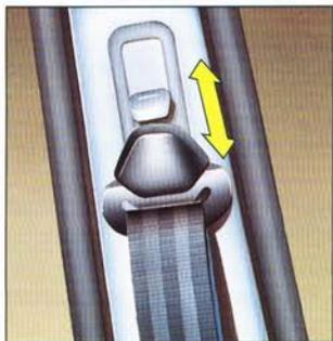
Votre véhicule est équipé aux places avant de ceintures à enrouleur réglables en hauteur avec prétensionneur et bloqueur de sangle. Selon version, deux des trois ceintures des places arrière sont à enrouleur.
